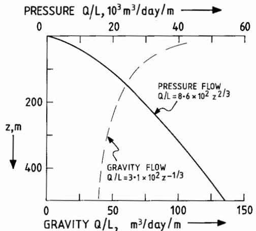
FIGURE 5. MAXIMUM Q/L VERSUS z FROM A VERTICAL FRACTURE
