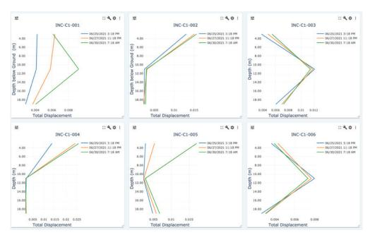
Figure 11 Inclinometer displacement data visualisation
